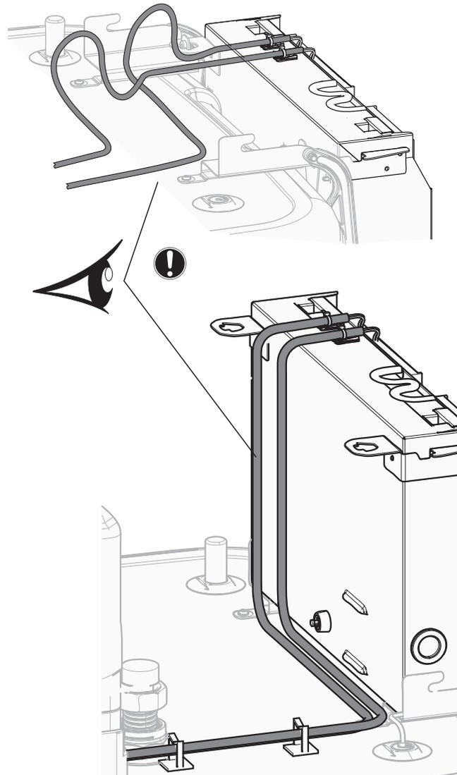
Alle Kabel, die an den Schaltkasten des ECH<sub>2</sub>O angeschlossen werden, müssen mit einer Zugentlastung fixiert werden.
