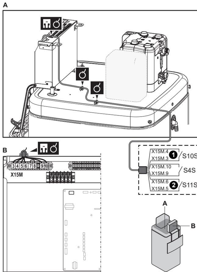
2 Fixieren Sie die Kabel mit Kabelbindern an den Kabelbinderhalterungen.
