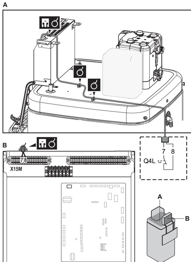
3 Befestigen Sie das Kabel mit Kabelbindern an den Kabelbinderhalterungen. Allgemeine Informationen finden Sie unter "9.3.1 Die elektrischen Leitungen an die Inneneinheiten anschließen" [▶ 123].
