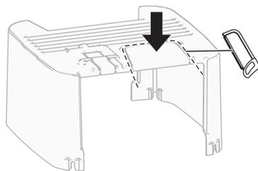
**7** Stützen Sie die Wasserleitungen ab.
