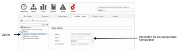
Abbildung 21: Einstellung der Zählerdaten auf der Monitoring-Plattform
