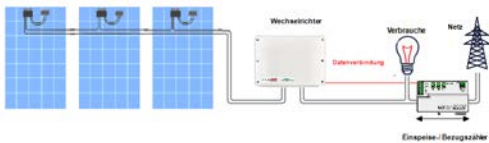
Abbildung 2: Typische Installation mit Produktionszähler
