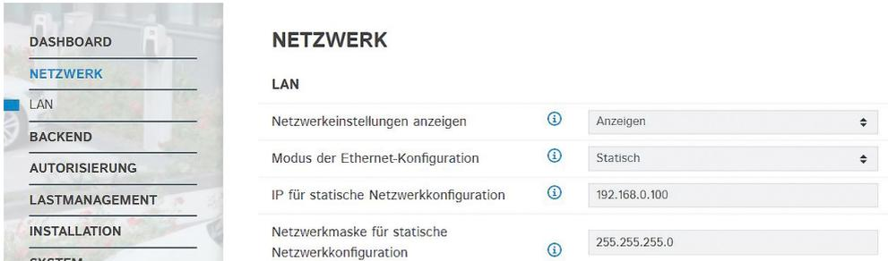
Abb. 12: Weboberfläche zur Konfiguration von statischen IP-Adressen
