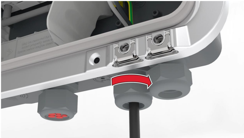
Abbildung 7: Verschraubung der Kabeldurchführung
