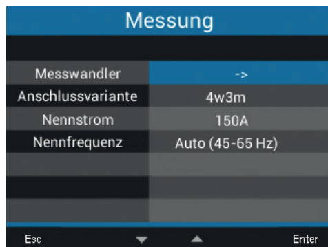
Abb. Fenster Messung mit aktiviertem Eintrag Messwandler.
