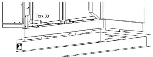
Lösen Sie die Befestigungsschrauben des vorderen Sockels. Unscrew the fastening screws of the front panel.
