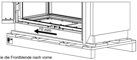
Schieben Sie die Frontblende nach vorne und entfernen Sie diese.
