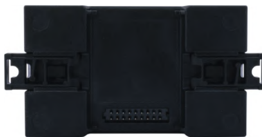
Abb.: Solar-Log Base mit ausgezogenen Rastnasen
