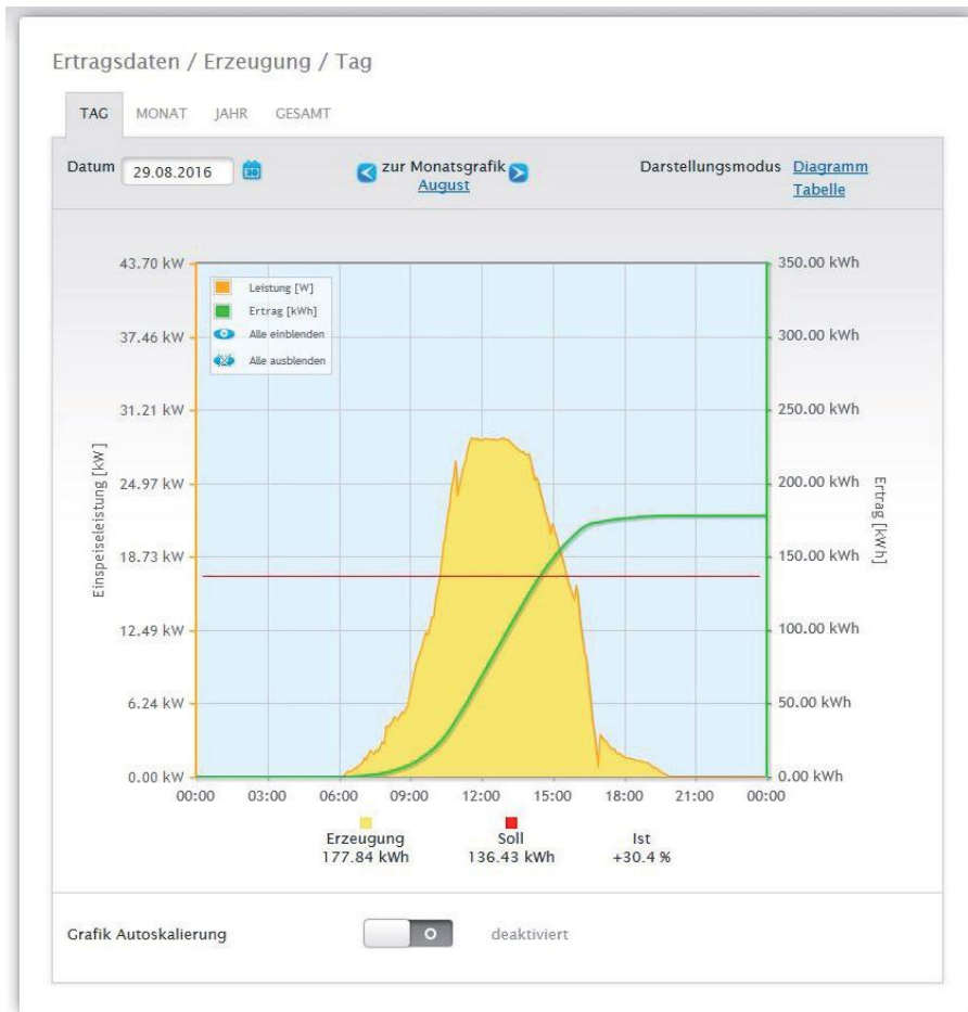
Abb.: Diagramm Tages-Ansicht Erzeugung mit deaktivierter Autoskalierung
