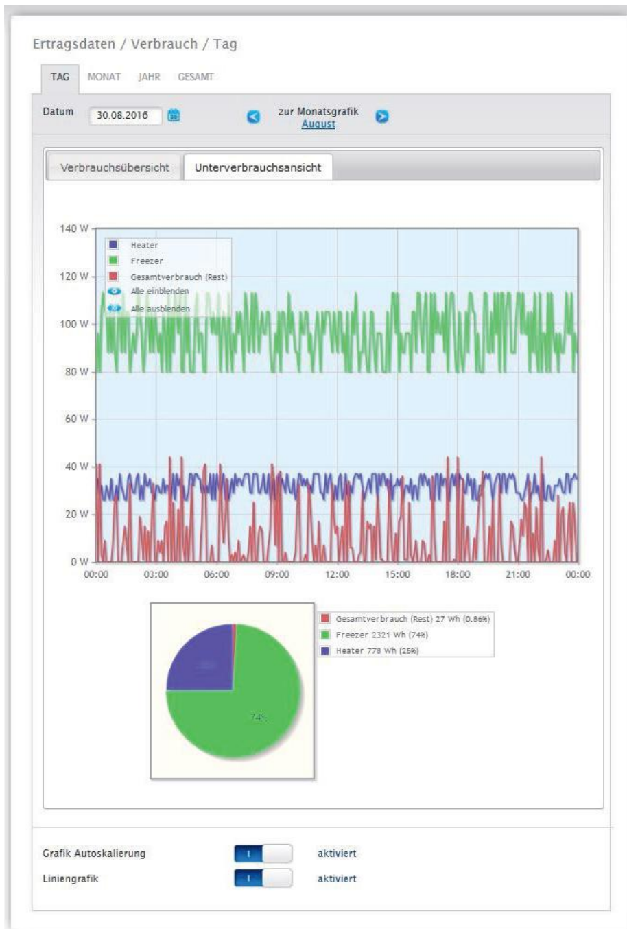
Abb.: Tagesverbrauchs-Diagramm mit angeschlossenen Verbrauchern und aktivierter Liniengrafik in der Unterverbrauchsübersicht
