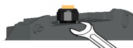
Abb. 6-15: Kabelverschraubung von der Rückseite festziehen
