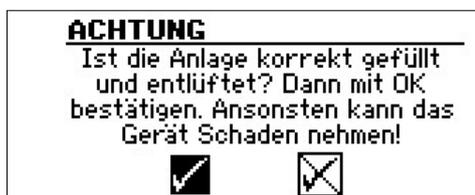
Die Sicherheitsabfrage erscheint immer beim Einschalten der Reglerspannung oder nach einem Neustart des Heizungs- und Wärmepumpenreglers (Reset). Sollte die Wärmepumpe oder der ZWE1 mehr als 10 Betriebsstunden aufweisen, wird dieser Bildschirm nicht mehr angezeigt.
