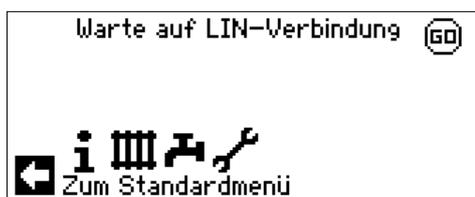
Nach Erlöschen dieser Anzeige kann das Gerät ordnungsgemäß betrieben werden. Ansonsten 3-polige Leitung für die BUS-Verbindung prüfen und gegebenenfalls Mangel beheben.
