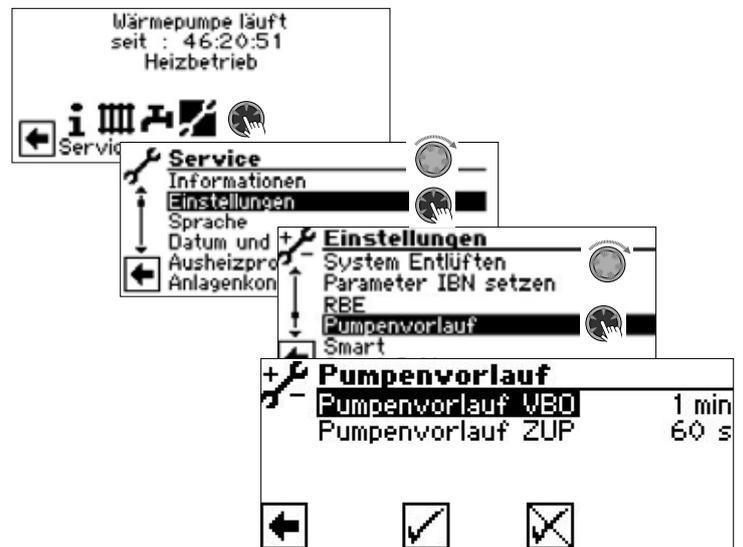
Pumpenvorlauf VBO Pumpenvorlauf Soleumwälzpumpe
